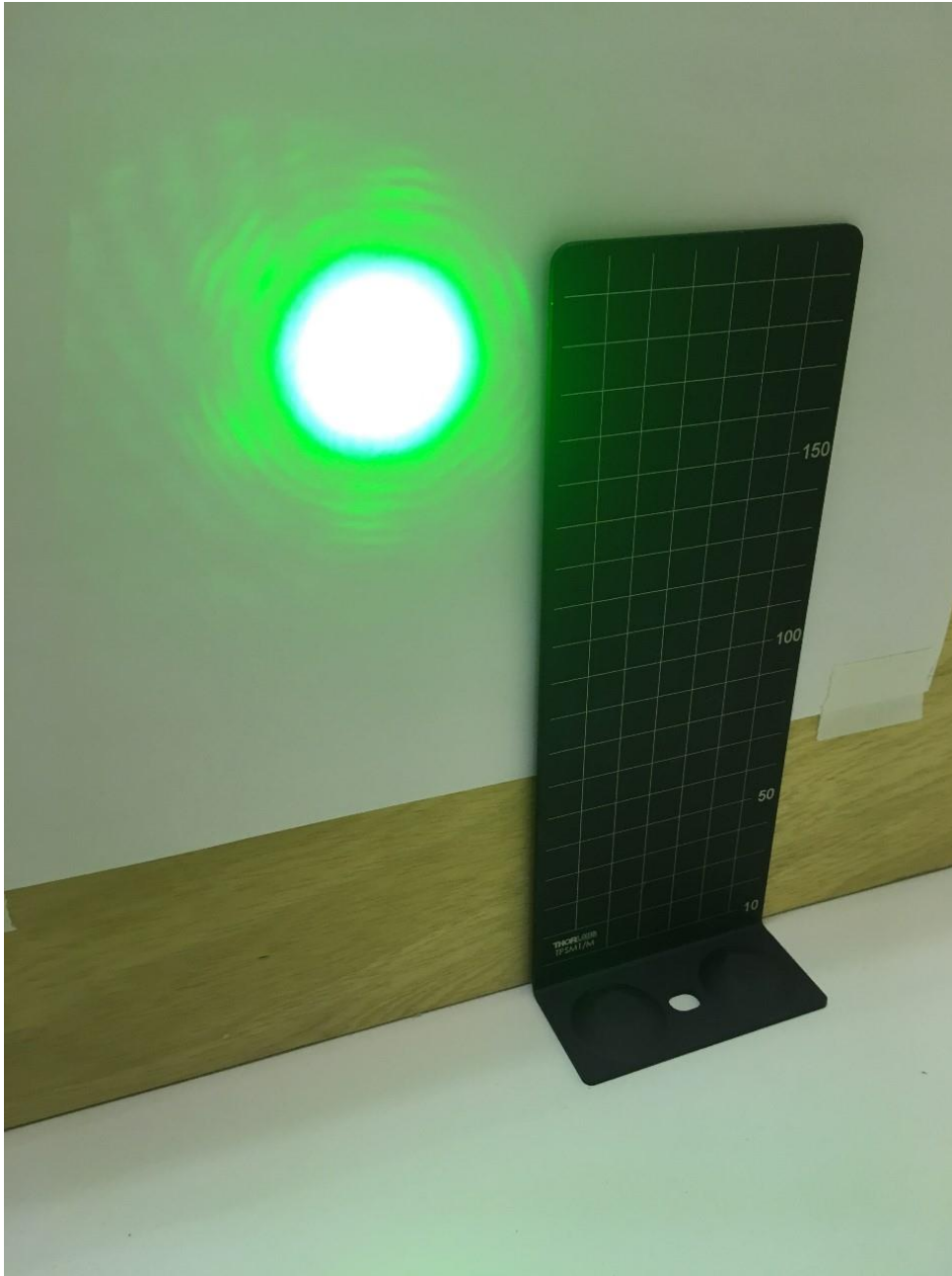
Fig. 2 Haz de láser supercontinuo a 532nm (Verde)
